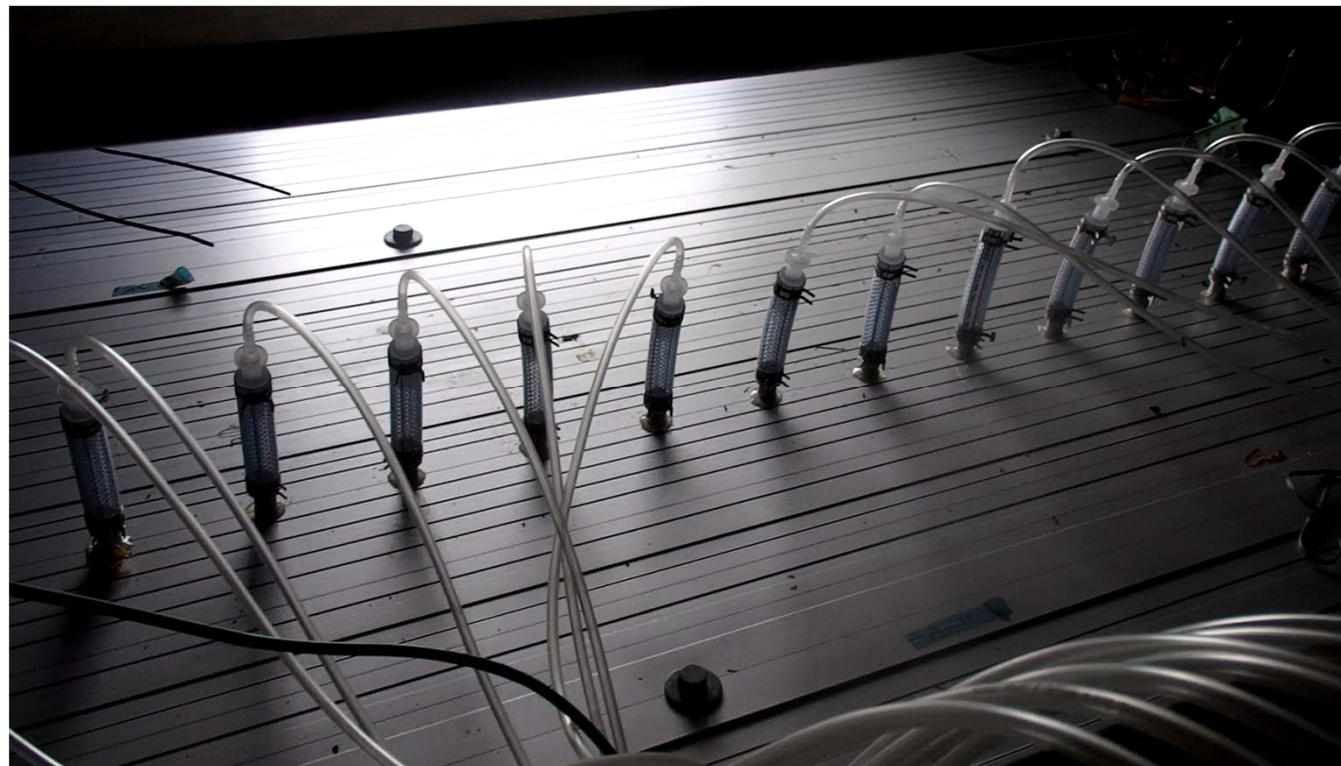
計測孔とセンサを校正チューブで接続
